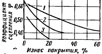
Рис. 57. Зависимость коэффициента сцепления от износа покрытия:
