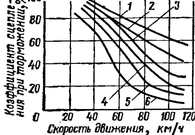
Рис. 61. Зависимость коэффициента сцепления от скорости движения при различной степени износа рисунка протектора:
